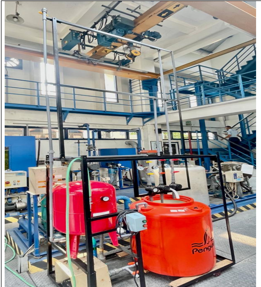
Gambar 1 Prototype sistem hydrophore (Sumber: Dokumen pribadi di Lab. Teknik Polimerin)
