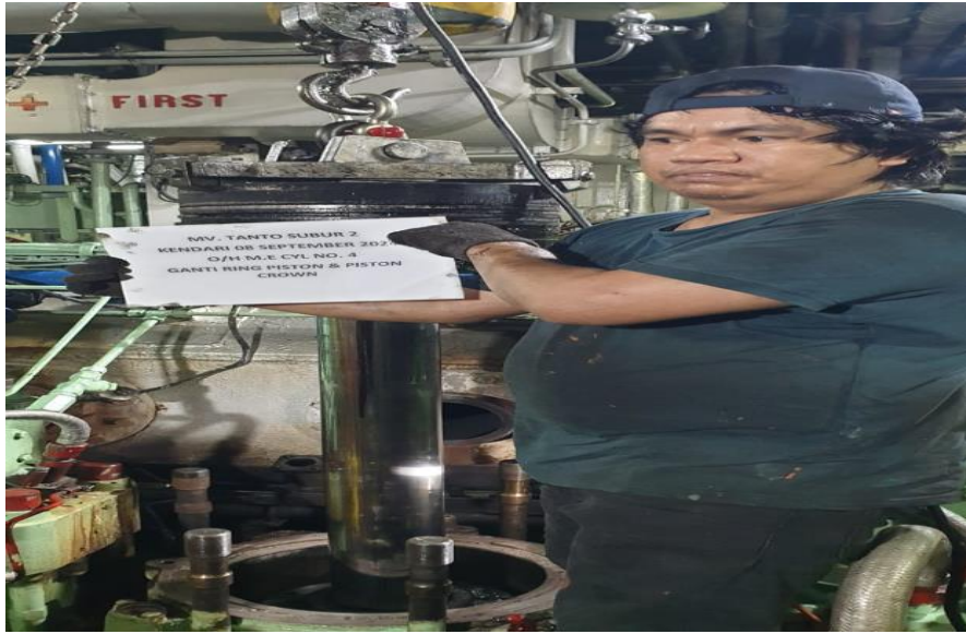
Gambar Bongkar piston dan crown (Sumber: Dokumen Pribadi, 2024)
