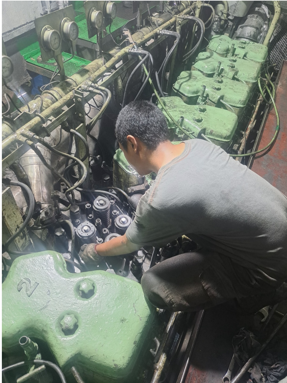
Gambar 5.4 Kegiatan di kapal Kegiatan: O/H Cylinder Head ME no.3
