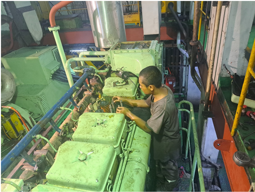
Gambar 5.6 Kegiatan di Kapal Kegiatan: O/H Cylinder Head AE no. 5
