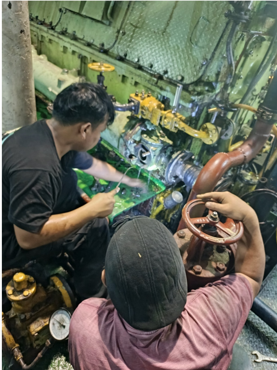
Gambar 5.2 Kegiatan di kapal Kegiatan: Sogok L.O Cooler Generator
