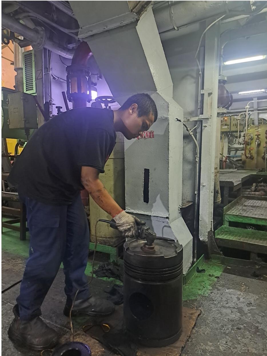
Gambar 5.3 Kegiatan di kapal Kegiatan: Brushing Piston Main Enggine
